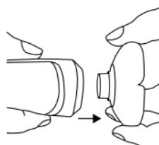
2. Tag fat i udsparingen på siden af den øverste del af klippehovedet, og træk klippeenheden af holderen til klippehovedet.
