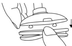
3. Держите режущий блок **2** под струей воды так, чтобы она проходила через режущие головки насквозь.
