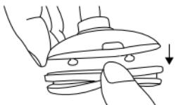
3. Trzymać jednostkę tnąca **2** pod bieżącą wodą, tak aby strumień wody przepływał od środka na zewnątrz przez głowice tnące.
