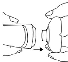
2. Ta tak i utsparingen på siden av den øvre delen av skjærehodet, og trekk skjæreenheten av skjærehodeholderen.
