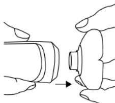
2. Greifen Sie in die seitliche Aussparung am oberen Teil des Scherkopfes und ziehen Sie die Schereinheit vom Scherkopfhalter ab.
