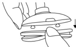
3. Tenere l'unità di rasatura **2** sotto acqua corrente in modo da far scorrere il getto d'acqua dall'interno verso l'esterno attraverso le testine .
