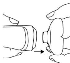
2. Afferrare l'incavo laterale nella parte superiore della testina e rimuovere l'unità di rasatura dal supporto della testina.
