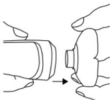
2. Pak de zijdelingse uitsparing in het bovenste deel van de scheerkop vast en trek de scheerunit los van de scheerkophouder.
