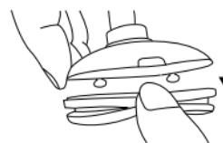
3. Hold skjæreenheten **[2]** under rennende vann, og la vannet strømme fra innsiden og ut gjennom skjærehodene.
