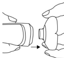
2. Возьмитесь за боковую выемку в верхней части режущей головки и снимите режущий блок с держателя режущей головки.
