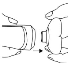
2. Agarre la ranura lateral de la parte superior del cabezal de corte y extraiga la unidad de corte del soporte del cabezal de corte.
