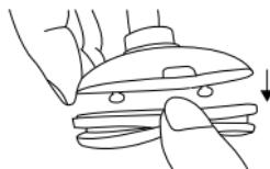
3. Hold klippeenheden **2** under flydende vand, så vandstrålen løber indefra og ud gennem klippehovederne.
