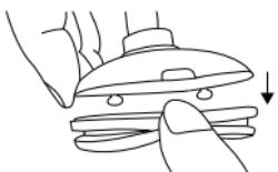
3. Passez l'unité de rasage sous l'eau courant **[2]** de manière à ce que le jet d'eau traverse les têtes de rasage de l'intérieur vers l'extérieur.
